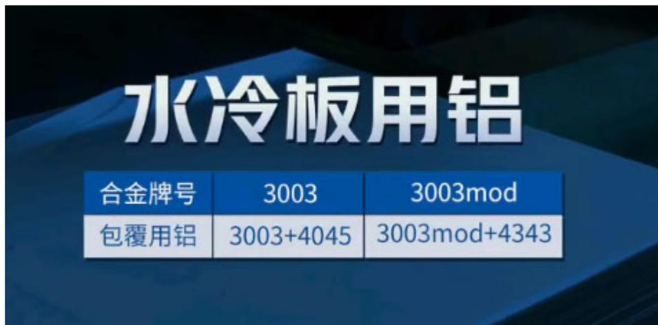
3003铝板性能优良，广泛用于汽车水冷板材料
